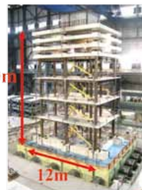
写真1： E-ディフェンスでの実大振動台実験 (ダンパーを設置した状態)
